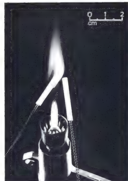
Hochtemperatur-Thermistor HT 103/750 für Temperaturen bis +1000 °C
