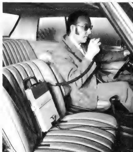
Der Sprechfunktende-Empfänger auf dem Beifahrersitz des Arztwagens
