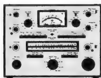
Frequenzanalysator 2120 mit aktivem RC-Bandfilter, Sperr- filter, Hochpaß und Tiefpaß. 2 Hz–20 kHz, relative Band- breiten 1%, 3% 10% und 23%.
